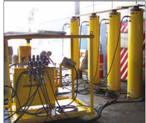
▲ Maßgeschneiderter doppeltwirkender Zylinder mit 500 t Hubkapazität und 1,83 m Hub zum Anheben eines elektrischen Seilbaggers.
