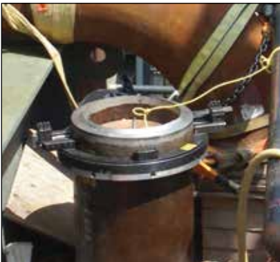
◀ Rohrtrenner der NB Narrow Body-Serie (Schmallbauweise).
