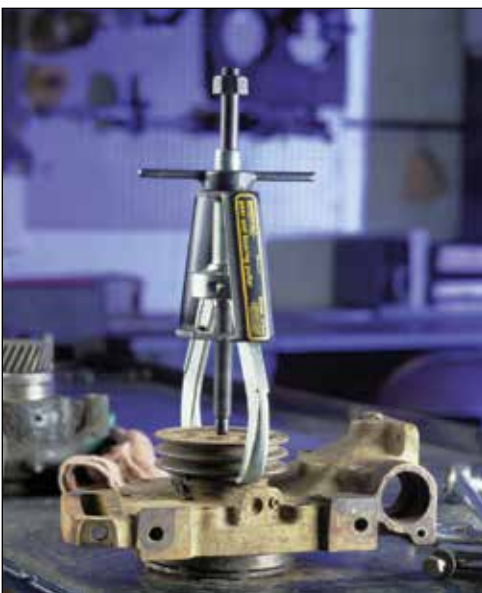
◀ Extracteur EP-204 à 2 griffes prêt pour extraire la poulie d'une pompe à eau.
